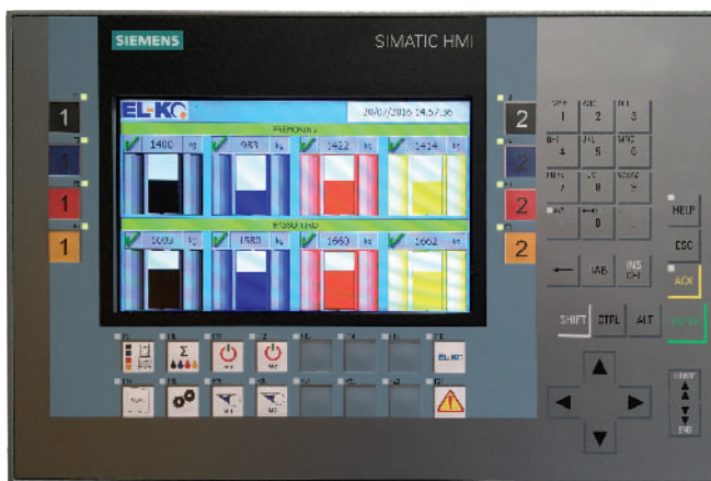
Sopra: terminale di controllo impianto di pompaggio inchiostri; a lato: impianto di pompaggio inchiostri con cisterne da 2500 Kg; sotto: controllo livelli inchiostro Lithoman.
