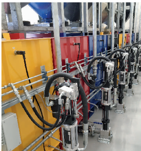
Sopra: terminale di controllo impianto di pompaggio inchiostri; a lato: impianto di pompaggio inchiostri con cisterne da 2500 Kg; sotto: controllo livelli inchiostro Lithoman.
